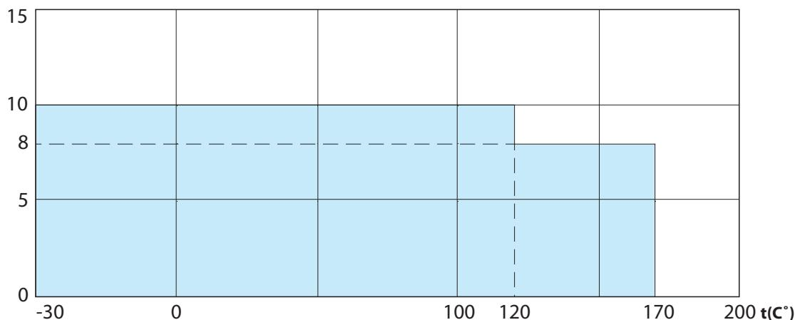
p Pressione massima nel corpo pompa - Max pressure in pump casing
