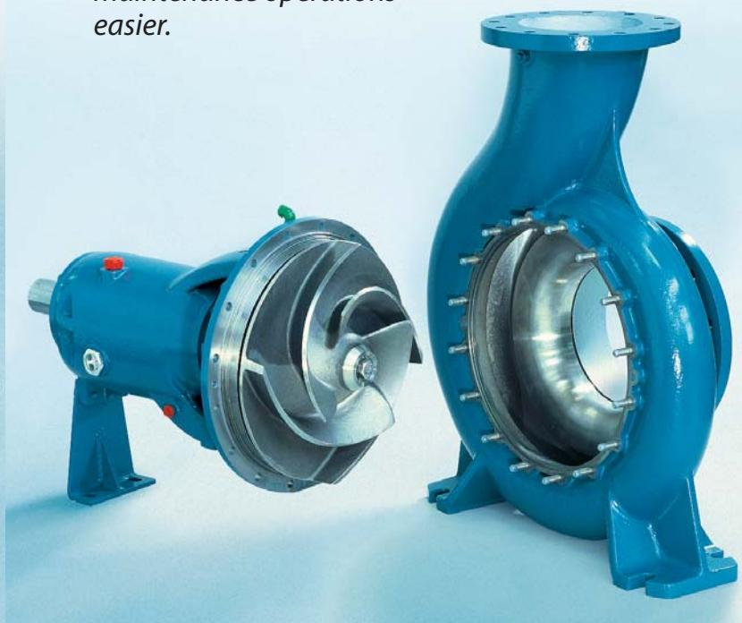
La girante delle pompe serie RACN/RACNS è del tipo aperto a canali con ampi passaggi per convogliare, senza alcun pericolo di intasamento, liquidi densi e/o altamente viscosi contenenti in sospensione corpi solidi non filamentosi, soluzioni con elevate percentuali di residuo secco.
