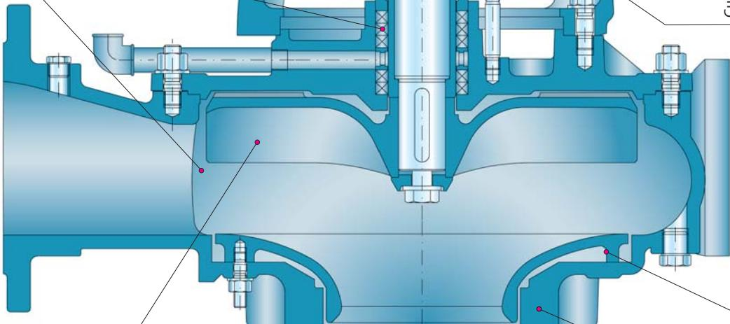
Tenuta a trecchia con sbarramento idraulico (a richiesta: tenuta meccanica semplice, bilanciata, doppia, tandem, a cartuccia, con quench).
