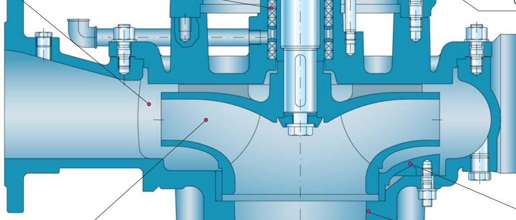
Bocca di aspirazione di grandi dimensioni per facilitare l'aspirazione di liquidi contenenti un'alta percentuale di solidi e per ridurre l'usura della girante.
